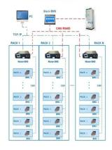
**BMS Wiring Diagram**
